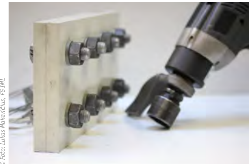
Pulverbeschichtete Prüfplatten mit Verschraubungen für Setz- und Kriechversuche
