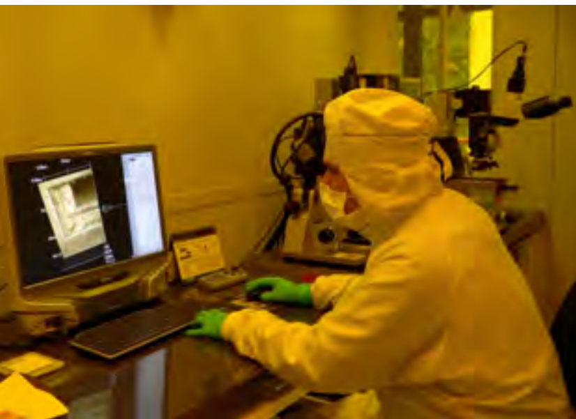
Mikroskopische 3D-Untersuchung einer fotolithografisch hergestellten Struktur, aufgenommen im Reinraum des Zentrums für Halbleitertechnik und Optoelektronik
