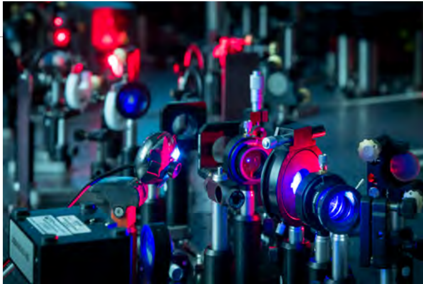
Optischer Aufbau zur Beobachtung des von drei ultrakurzen Laserpulsen in einem Beta-Barium-Borat Kristall generierten Vier-Wellen-Mischsignals
