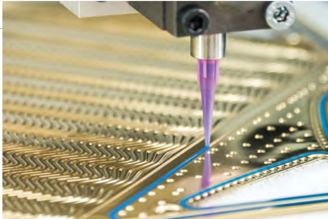
Dispensieren einer Dichtung auf eine metallische Bipolarplatte Dispensing of a sealant onto a metallic bipolar plate
