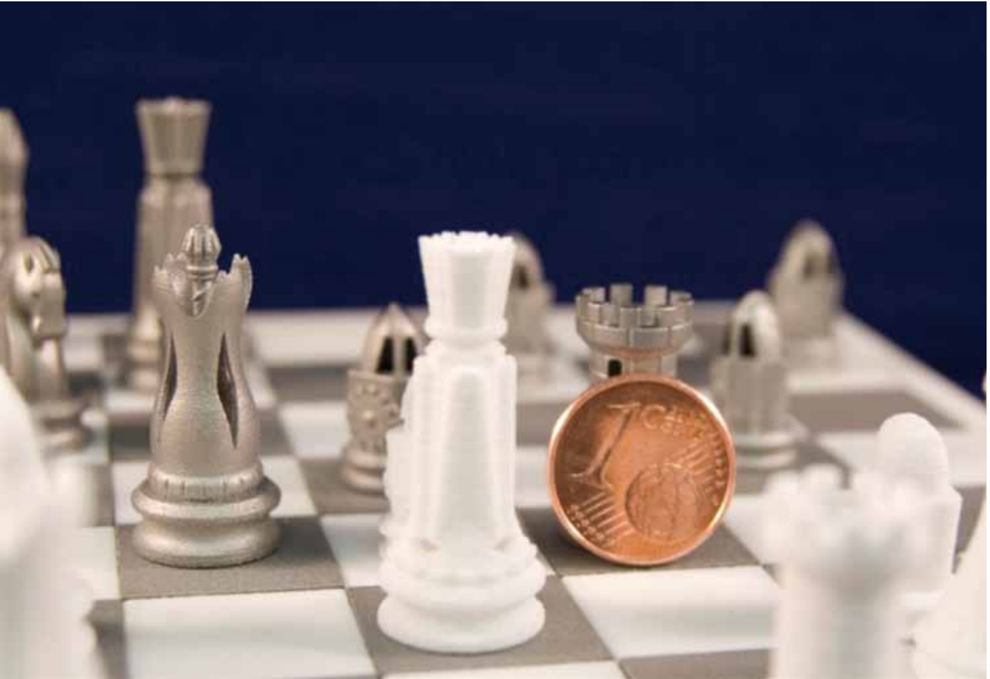
Schachfiguren als Beispiel additiver Fertigung: „Schwarz“ aus Metall, hergestellt durch Laser-Strahlschmelzen, „Weiß“ aus Kunststoff, durch Laser-Sintern
