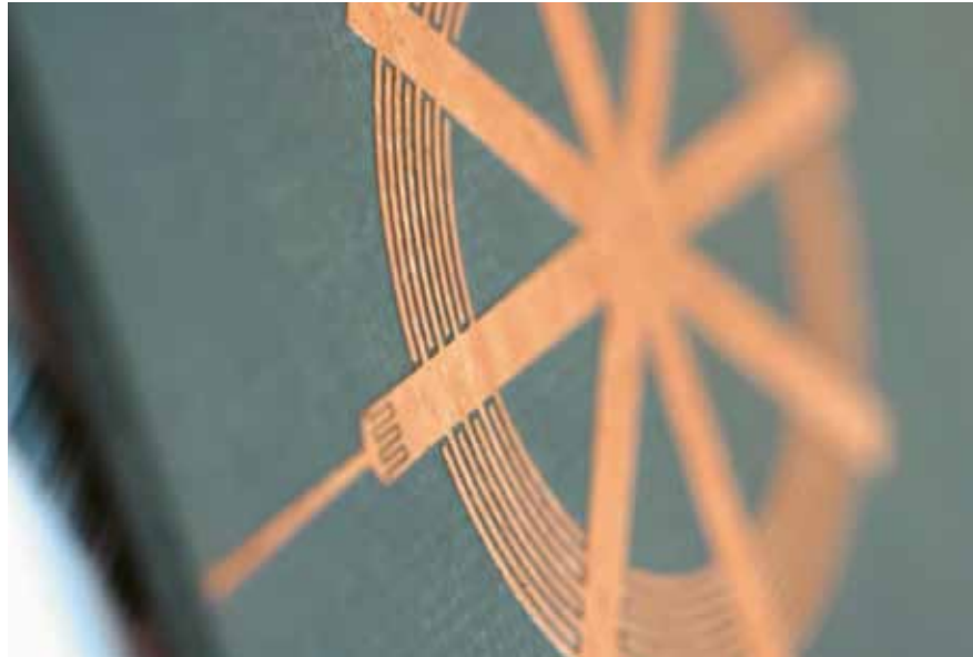
Metamaterial-basierte, zirkular polarisierte Dualband-Ringantenne für den Mikrowellenbereich
